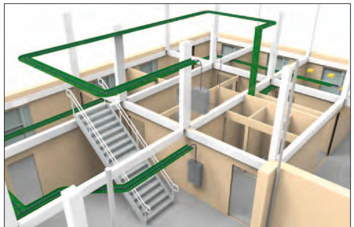
**Die etagenübergreifende Kabelführungen wurde vereinfacht und erlaubt nun auch in komplexen Gebäudemodellen die vollständige Ermittlung der Spannungsfälle**
