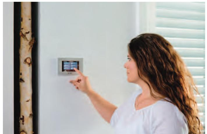
**Per MultiTec Touch-868 lässt sich die Haustechnik zentral vom Wohnzimmer aus steuern – ein Berühren des modernen Displays mit übersichtlicher Oberfläche genügt. Jalousien, Screens, Rollläden und Beleuchtung können in 20 Kanäle eingelernt und einzeln, in individuell eingeteilten Gruppen oder alle zugleich angesprochen werden. Auch eine Zeitschaltuhr für automatische Abläufe ist integriert**
