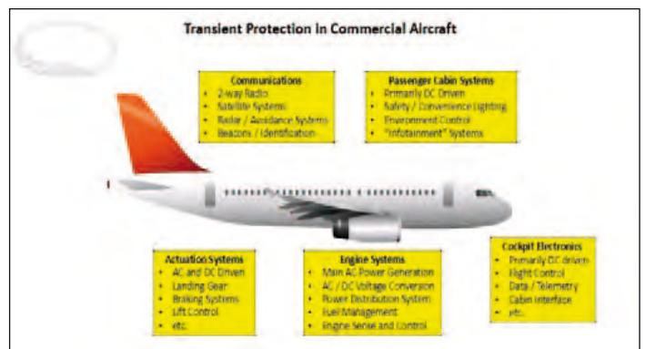
Links ein Blockdiagramm für eine Motorsteuerung, rechts ein Beispiel für einen Überspannungsschutz in kommerziellen Flugzeugen
