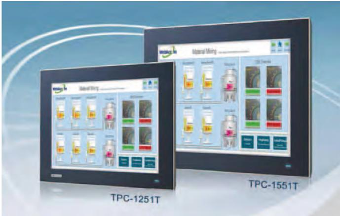
Mit der TPC-xx51-Serie stehen moderne, lüfterlose Touch Panel Computer für Thin Client HMI Anwendungen im rauen industriellen Umfeld mit Displaygrößen zwischen 5,7 und 17 Zoll für die Maschinen- und Anlagenautomation zur Verfügung. Die mit einem echtem
