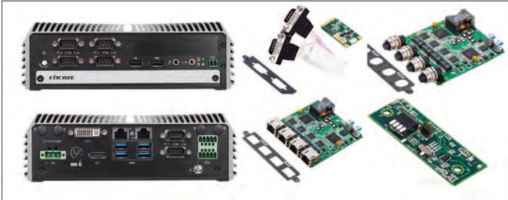
Links die Front- und Rückansicht des DI-1000, rechts die DI-1000 Module
