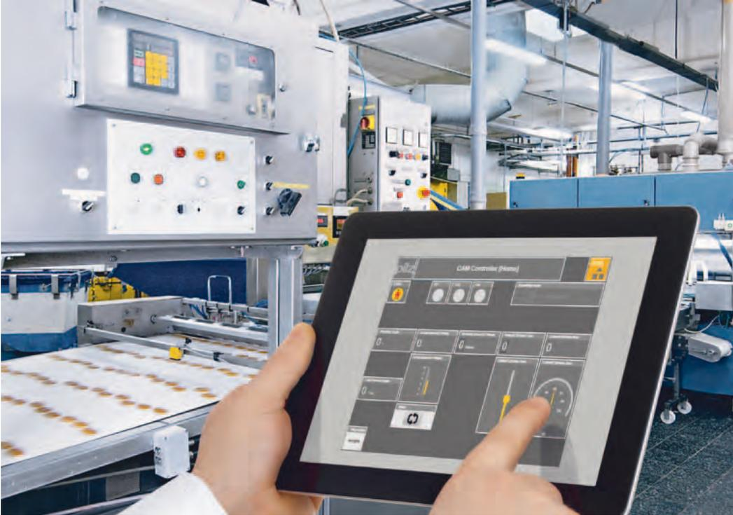
Die webbasierte Visualisierungssoftware **PASvisu** von Pilz beruht auf aktuellsten Webtechnologien und stellt eine leistungsstarke, einfach handhabbare Lösung für den Bereich Bedienen und Beobachten dar
