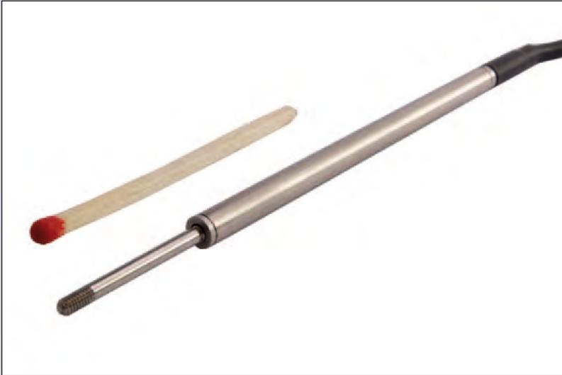
*Kaum größer als ein Streichholz: Die Wegsensoren der Baureihe IZAL von Inelta mit einem Außendurchmesser von 4 mm und einer Gehäuselänge von 55 mm*
