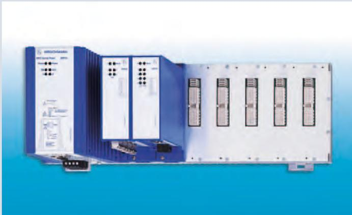
Belden Inc. hat sein Produktprogramm um den neuen MSP40 Switch, der speziell für umfangreiche industrielle Ethernet-Netzwerke entwickelt wurde, erweitert. Dieser kompakte und extrem robuste Layer-3-Switch hat 28-Gigabit-Ports - nach eigenen Angaben mehr als jedes andere vergleichbare Gerät auf dem Markt -, die sich austauschen lassen und Datenraten von bis zu 2,5 Gbit/s unterstützen. Eine zuverlässige Datenübertragung mit
