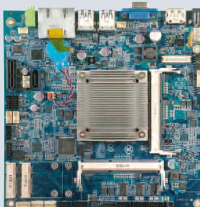
Drei unabhängige Displayanschlüsse sind über 1x eDP und 2x DP++ gegeben. Ausgestattet mit diversen I/O-Schnittstellen, wie PCIe GbE LAN, USB 3.0, USB 2.0, SATA 6G/s, COM, Micro-SD, Digital I/O und Audio, bietet das Motherboard alle gängigen Anschlussmöglichkeiten. tKINO-AL ist eine kompakte Embedded Computing Plattform für Anwendungen in unterschiedlichen Marktsegmenten der Industrie, die voraussichtlich ab Juli 2017 verfügbar sein wird.
