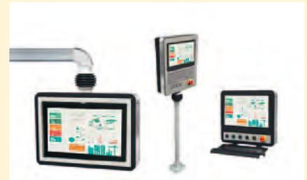
Durch den Einbau in ein rundum IP65 geschütztes Aluminiumgehäuse und die Anbringung stehender und hängender Tragarmvarianten (IP54, dreh- und neigbar) mit innenliegender Kabelführung wird Ergonomie mit optimalem Schutz in rauer Umgebung verbunden. Im Gegensatz zu den vordefinierten Standardlösungen mit 15" ... 24" Displaydiagonalen bilden die Gehäusevarianten „Customized“ und „Project“ eine maßgeschneiderte Lösung für den Anwender. Die „Customized“ Lösungen bieten vor-
