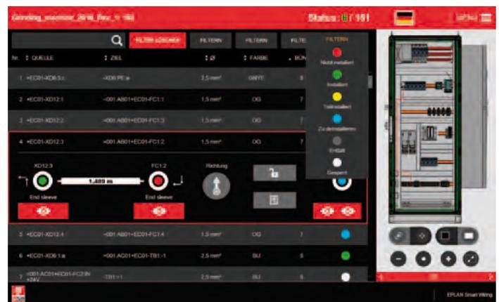
**Mit Eplan Smart Wiring wird die Schaltschrankverdrahtung Schritt für Schritt visualisiert. Nach jedem ausgeführten Arbeitsschritt wird der Projektstatus für eine lückenlose Dokumentation aktualisiert (Quelle: Eplan)**
