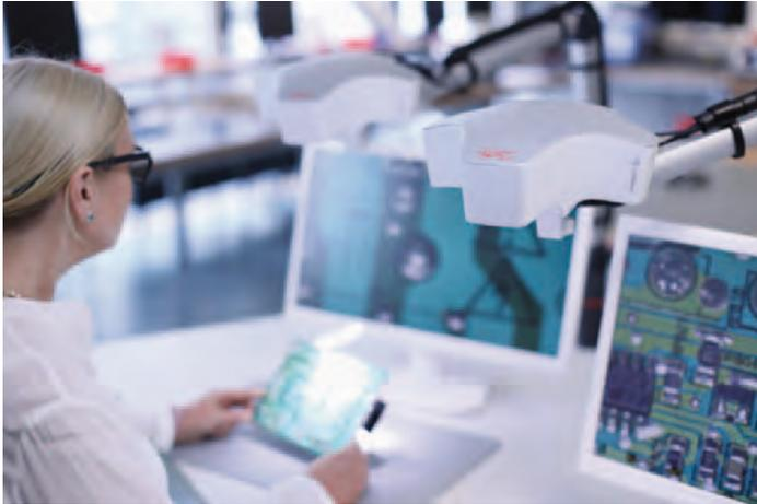
Lupenbrillen und Stereomikroskope in unterschiedlichster Form zählen zum festen Bestandteil der Qualitätssicherung und unterstützen filigrane Feinarbeit.
