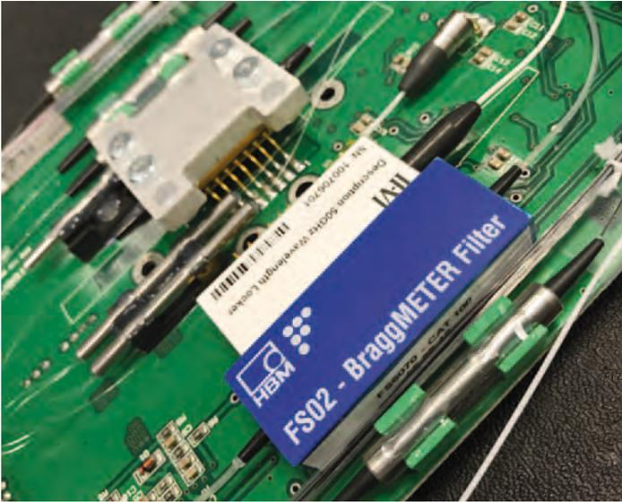
Das einzigartige Filter FS02-BraggMETER, eine zuverlässige Komponente, die sich in optischen Interrogatoren der Spitzenklasse von HBM FiberSensing seit langem bewährt hat, ist nun auch als Standardprodukt lieferbar. Mit sei-
