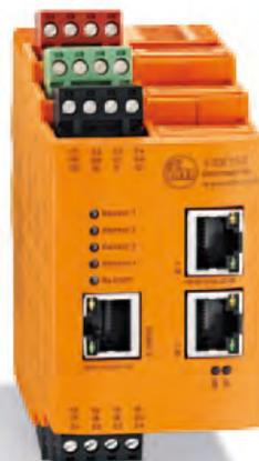
so frühzeitig erkannt, Ausschuss und kostspielige Schäden vermieden. Durch die Feldbusanbindung lassen sich Messwerte direkt in der Steuerung anzeigen und die Überwachung perfekt an die Betriebszustände und Prozesse der Maschine anpassen. Zwei digitale Schaltausgänge (Reaktionszeit  $\leq 1$  ms) für zeitkritische Alarmer, drei Ethernet-Ports, ein großer interner Historienspeicher mit Echtzeituhr und Zähler sind weitere Hauptmerkmale der VSE150.
