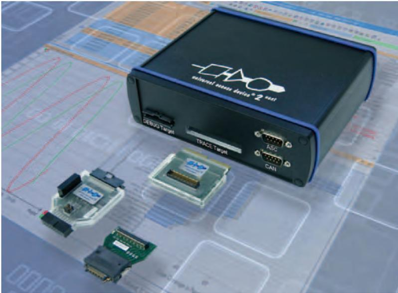
**Das neue UAD2next kombiniert volle Debug-Funktionalität und ein CAN-Interface mit einem flexiblen und modularen Trace-Interface-Konzept**
