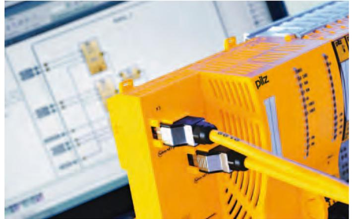
**Die Steuerungen PSSuniversal PLC gehören zum Automatisierungssystem PSS 4000 von Pilz. Sie eignen sich zur Realisierung komplexer, verketteter Maschinen und Anlagen**
