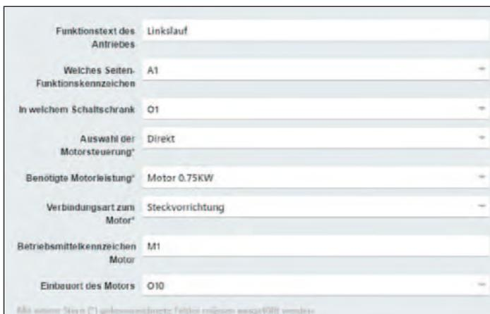
Über Mini-Konfiguratoren – hier am Beispiel einer Motorsteuerung – wählt der Anwender entsprechende Parameter aus und Eplan Cogineer generiert die korrekte Steuerung (Bilder: Eplan Software)
