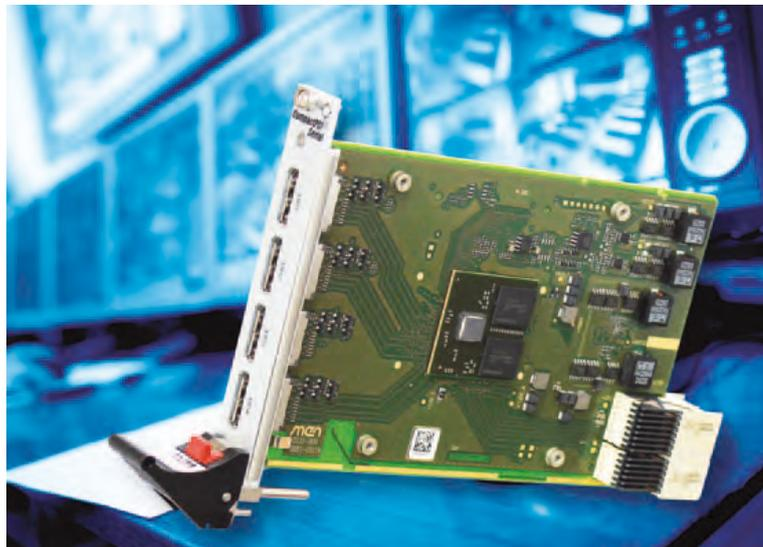
Standardmäßig ist die G232 an der Front mit drei DisplayPort-1.2-Schnittstellen mit einer max. Auflösung von 2560 x 2048 bei 60 Hz und einer Farbtiefe von 30 bpp, sowie einer DisplayPort-1.1a-Schnittstelle mit einer max. Auflösung von 2560 x 1600 bei 60 Hz und einer Farbtiefe von 24 bpp ausgestattet.
