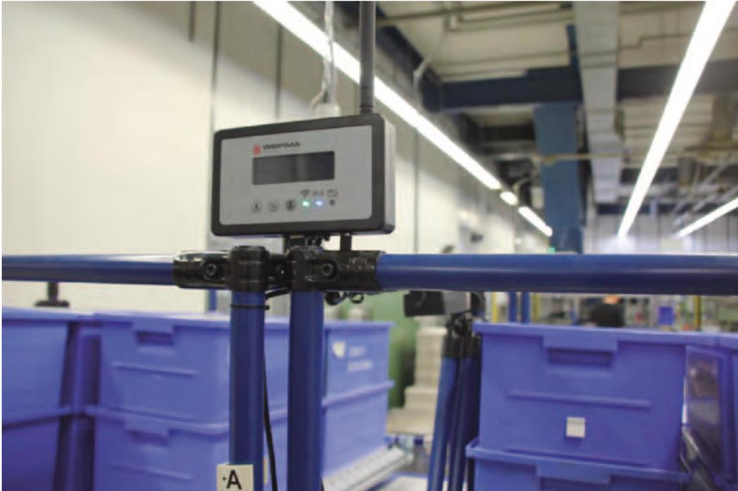
**Die SmartBOX übermittelt die Daten der Sensoren über ein intelligentes Funknetz**
