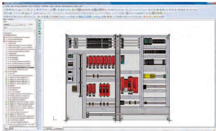
**Virtueller Montageaufbau mit Eplan Pro Panel auf Basis der im Hardware-Engineering definierten Betriebsmittel (Quelle: Bauer Steuerungstechnik)**
