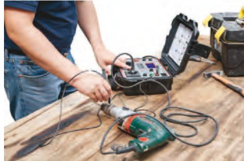
Mit diesem tragbaren Gerätetester verfügen Anwender über eine universelle und effiziente Lösung mit allen Funktionen zum Prüfen ortsveränderlicher Geräte. Jede Messfunktion ist mittels Drehschalter auswählbar.
