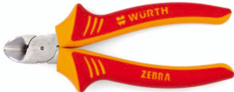
lagertem Drehpunkt beim neuen Würth Seitenschneider „plus 20%“ stellt im Prinzip einen deutlich verlängerten Hebel dar. Auf diese Weise können – im Vergleich zu herkömmlichen Produkten – bis zu 20% höhere Schneidkräfte erzeugt werden. Alternativ lässt sich die für einen Schnitt aufzubringende Handkraft um den gleichen Betrag reduzieren. Dabei ist für den Anwender vor allem der letzte Fall vorteilhaft, denn die Kraftersparnis verringert bei serienmäßigem Arbeiten die
