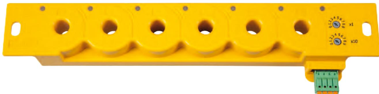
Entwickelt wurde das sechskanalige Differenzstrom-Überwachungssystem RCMS150 für Endstromkreis-Applikationen, die wenig Platz bieten und trotzdem allstromsensitiv (Typ B) überwacht werden müssen. Auffällig ist die kompakte Bauform, da das Auswertegerät mit sechs Messstromwandlern eine Einheit bildet. Das hat unter anderem den Vorteil, dass nur eine Versorgung notwendig ist. Die Befestigung des
