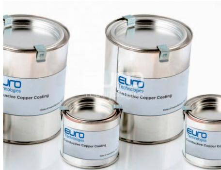
Leitlacke bestehen aus einer Mischung von Lackfarben mit Mikropartikeln aus Silber, Kupfer oder Nickel. Vor dem Aufbringen ist nur eine minimale Untergrundbehandlung erforderlich. Das Anstrichergebnis ist sehr abriebfest, feuchtigkeits- und wärmebeständig. Erhältlich sind die Lacke bei Euro Technologies.
