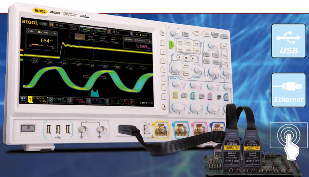
Bandbreite bis 500 MHz, 10 GS/s. • 4 Kanäle. • 16 Logik-Kanäle. • Tiefer Speicher. • Touchscreen.
