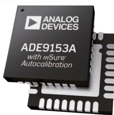
ausgelegt sind, können während der Produktion eine Selbstkalibrierung vornehmen, sodass auf den Bau, die Installation und die Unterhaltung von Präzisions-Kalibrierplätzen in der Produktionsstätte verzichtet werden kann.
