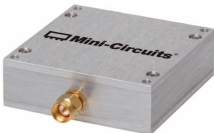
Von Mini-Circuits kommt mit dem ZABP-598+ ein koaxiales Bandpassfilter mit einem Durchlassbereich von 410 bis 785 MHz. Dieses Filter verträgt eine Eingangsleistung von 1 W, weist typisch 2,7 dB Einfügedämp-
