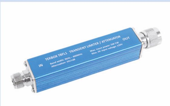
Der Tekbox TBFL1 kombiniert einen Transienten-Limiter (Begrenzer), einen Abschwächer (Dämpfungsglied) und ein Hochpassfilter in einem Gerät. Er wird in den Signalpfad eingeschleift, um den Eingang von Spektrumanalysator oder Messempfänger optimal zu schützen. Dies gilt insbesondere für die
