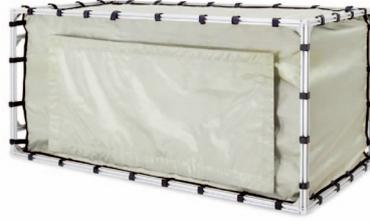
Schirmgewebe von besser als 58 dB im Bereich DC bis 1,5 GHz. Damit eignet es sich sowohl für die Messung abgestrahlter als auch leitungsgebundener Störungen. Externes Störspektrum, welches die Interpretation der Messergebnisse oft unnötig erschwert, kann dadurch zuverlässig ausgeblendet werden. Auch für Störfestigkeitsmessungen lässt sich das Abschirmzelt einsetzen und verhindert so Störungen der Messtechnik und der Umgebung.
