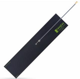
Die FXUB64.18.0150A ist eine LTE-Breitband-Flex-Antenne mit >45% Wirkungsgrad auf allen Bändern und 6 dBi Spitzen-Gewinn, Abmessungen: 130 x 30 x 0,2 mm
