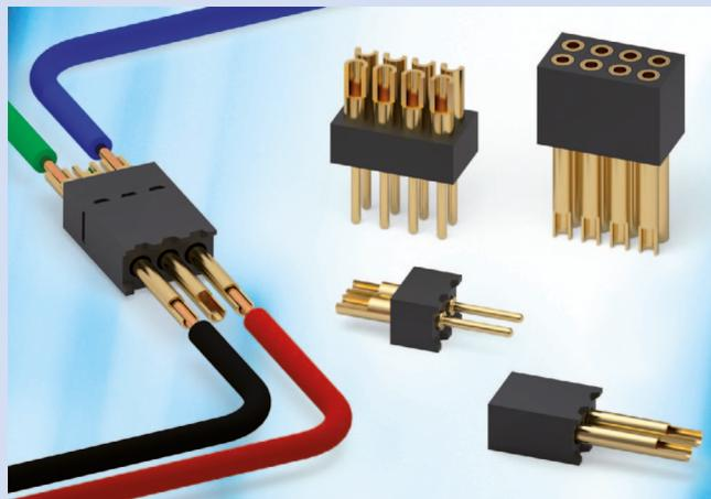
Mill-Max stellte eine neue Serie von Stift- und Buchsenleisten mit rückseitigen Lötkelchen im Raster 1,27 mm vor. Die einreihigen Stift- (850-10-0XX-10-003000) und Buchsenleisten (851-13-0XX-10-003000) sind mit einer bis 50 Positionen, die doppelreihigen Stift- (852-10-XXX-10-003000) und Buchsenleisten mit zwei bis 100 Positionen erhältlich. Sie sind optimal geeignet für höchstzuverlässige Steckverbindungen in sehr kompakten Abmessungen.
