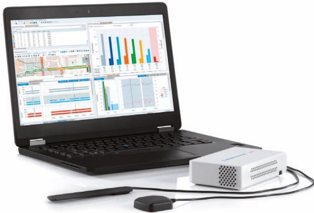
Rohde & Schwarz Mobile Network Testing präsentierte die weltweit erste Lösung zum Testen von 5G-NR-Mobilfunknetzen (5G New Radio). Damit können Anwender im 5G-Mobilfunknetz-Ökosystem sowie Regulierungsbehörden die Versorgung in 5G-NR-Mobilfunknetzen präzise messen – eine der größten Herausforderungen bei der Netzplanung. Darüber hinaus lässt sich damit der ordnungsgemäße Betrieb der
