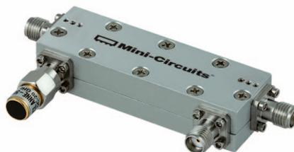
Von Mini-Circuits stammt der neue koaxiale Richtkoppler ZUDC10-02183+. Dieser bedient eine breite Palette von Anwendungen im Frequenzbereich 2 bis 18 GHz. Dieser Richtkoppler weist 10 dB Koppelfaktor auf, wobei die Flatness mit  $\pm 0,4$  dB über den Arbeitsfrequenzbereich besonders gut ist. Der Richtkoppler verträgt Eingangslei-
