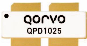
Der von Qorvo produzierte QPD1025 ist ein 1,8-kW-HEMT (P3dB) in GaN-on-SiC-Technik für Einsatzfrequenzen von 1 bis 1,1 GHz. Eine interne Eingangsanpassung hält die Außenbeschaltung gering. Das Bauteil erlaubt vorteilhaft sowohl CW- als auch gepulsten Betrieb. Die lineare Verstärkung wird mit 22,5 dB angegeben, die typische PAE3dB mit 77,2%; die Nennbetriebsspannung beträgt 65 V. Applikationsmöglichkeiten liegen z.B. in den Bereichen IFF-Transponder und Avionics.
