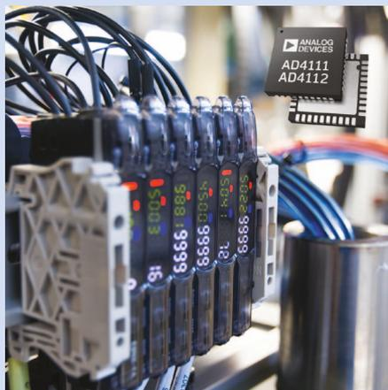
Diese ADCs arbeiten auch mit ±20 V und erweitern so den Nenn-Eingangsspannungsbereich. Außerdem akzeptieren sie Ströme von -0,5 bis 24 mA unter Einhaltung der Leistungsspezifikationen. Dies ermöglicht zuverlässige Messungen nahe bei 0 mA und bietet einen Zusatzbereich (Over Range Margin) von über 20 mA. Für beide Bauteile ist ein absoluter Maximalbereich von ±50 V an den Spannungsanschlüssen und ±50 mA an den Strompins
