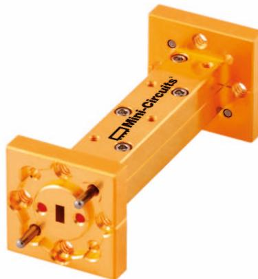
Von Mini Circuits und Virginia Diodes kommen mit der neuen Serie WVBP Hohlleiter-Bandpassfilter für diverse Bänder zwischen 27 und 86 GHz. Die Systemimpedanz beträgt 50 Ohm, die Einfügedämpfung wird mit typisch 0,5 dB, die Rückflusdämpfung mit typisch 26 dB angegeben. Der Einsatztemperaturbereich ist -40 bis +85 °C.
