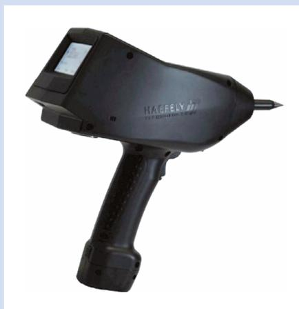
Impulse nach IEC/EN 61000-4-2 mit 16 oder 30 kV. Weil die Bedien- und Steuereinheit in der Pistole verbaut ist und der Betrieb über Akku erfolgt, ist endlich eine einfache und problemlose Nutzung einer ESD-Pistole an allen Arten und Größen von Teststandorten möglich. Mit einem passenden Prüftisch und einem normgerechten Prüfaufbau lassen sich so ganz einfach ESD-Tests an Geräten im eigenen EMV-Labor durchführen.
