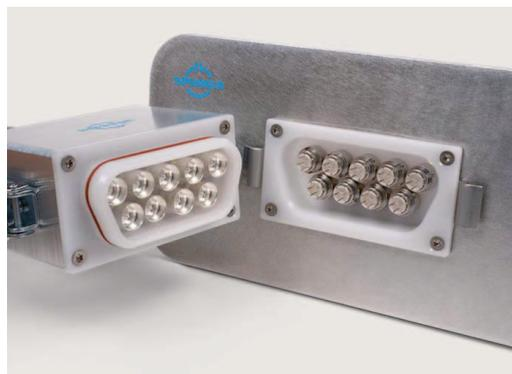
**Das Gehäuse des Clusters ist asymmetrisch aufgebaut. Damit lässt es sich intuitiv stecken, was eine fehlerhafte Montage ausschließt**
