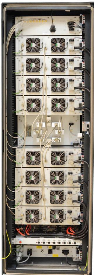
**Familie AM96: Holographischer Radar-Transmitter-Verstärker (rückseitige Ansicht)**
