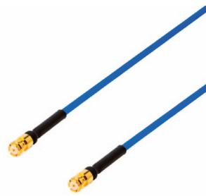
bei Signalen im Frequenzbereich von DC bis 18 GHz. Die Kabel können ohne Spezialwerkzeug von Hand in einen Radius von nur 3,2 mm geformt werden, um eine extrem dichte Schaltung und Systemverpackung zu gewährleisten. Das Modell 047-6SMP+ ist beispielsweise eine 6 Zoll lange Hand-Flex-Baugruppe mit SMP-Schnellverbindungs-/Trennbuchsen.
