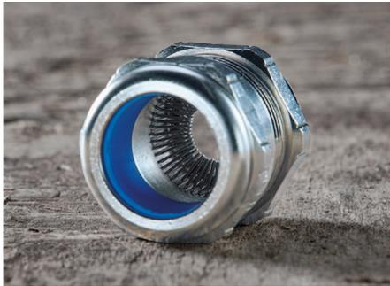
**Bessere Schirmwirkungen lassen sich erzielen, wenn das Schirmgeflecht des Kabels durchgängig bis zur Elektronik im Schaltschrank geführt und erst dort an Masse angeschlossen wird wie bei den Kabelverschraubungen TRI durch die 360°-TRI-Feder-Kontaktierung möglich**
