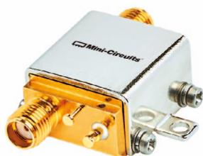
Der ZX60-022 03LPN+ von Mini-Circuits ist ein Breitbandverstärker, der eine Kombination aus hoher Verstärkung, mittlerer Leistung und hohem IP3 über einen sehr weiten Frequenzbereich bietet und eine Vielzahl von Anwendungen unterstützt. Die mittlere Leistung wird mit 15 dBm bei 1 dB Kompression angegeben. Die Verstärkung beträgt nominell 16 dB bei ausgezeichneter Verstärkungseben-
