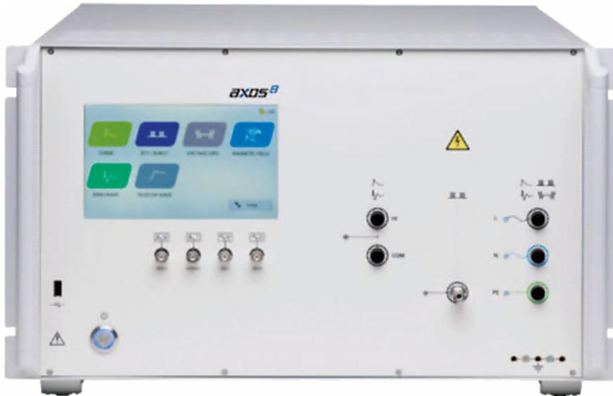
Der Fast-Transient-Burst-Test nach IEC/EN 61000-4-4 simuliert Störungen, die bei Einschaltvorgängen großer Verbraucher oder durch einen schlecht entstörten Elektromotor mit Bürstenfeuer auf Leitungen verursacht werden. Der Surge-Test nach IEC/EN 61000-4-5 simuliert die Auswirkungen von Blitzschlägen auf das Stromnetz oder das Abschalten schwerer Lasten. Netzunterbrechungen und Spannungseinbrüche nach IEC/EN 61000-4-11 sind Prüfungen auf Störfestigkeit gegen schwankende Netzqualität.
