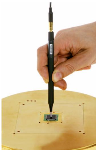
Untersuchungen der Störfestigkeit an integrierten Schaltkreisen und Leiterplatten sind wichtig zur entwicklungsbegleitenden Prüfung von Bauelementen und Baugruppen. Die Langer EMV-Technik GmbH bietet mit den Magnetfeldquellen der Sets H4-IC und H5-IC spezialisierte Werkzeuge zur kleinräumigen Einspeisung von Burstimpulsen in ICs, Leitungsstrukturen und Baugruppen an.
