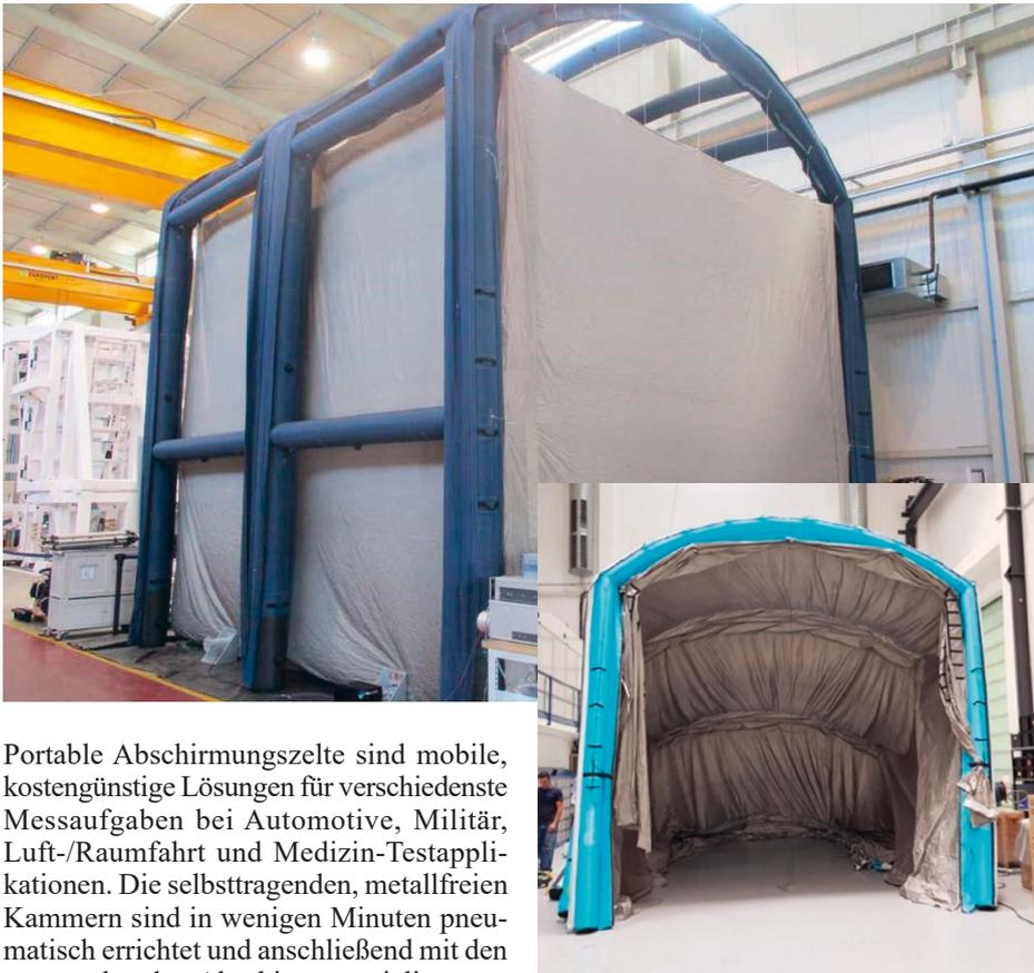
Portable Abschirmungszelte sind mobile, kostengünstige Lösungen für verschiedenste Messaufgaben bei Automotive, Militär, Luft-/Raumfahrt und Medizin-Testapplikationen. Die selbsttragenden, metallfreien Kammern sind in wenigen Minuten pneumatisch errichtet und anschließend mit den entsprechenden Abschirmmaterialien ausgekleidet. Die Zelte sind für Innen- und Außenbereiche geeignet und können ebenso schnell wieder abgebaut und kompakt verstaut werden.
