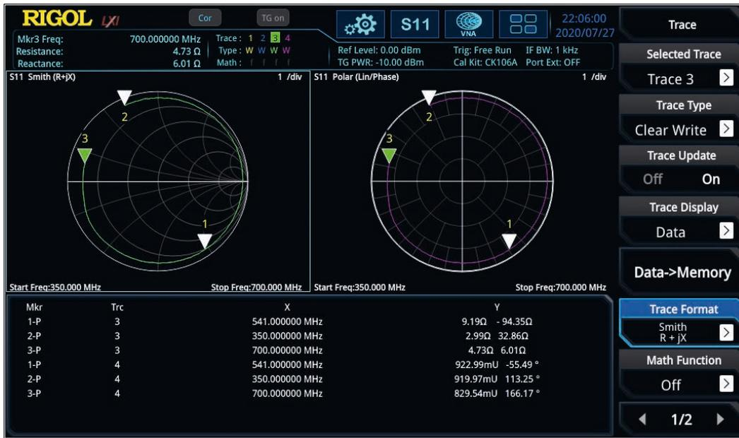
**Bild 3: Frequenzgangkurve; die Frequenz steigt im Uhrzeigersinn an**
