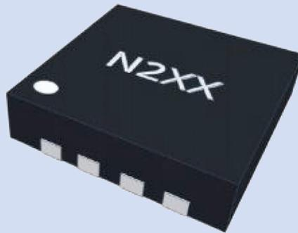
Bei Betrieb an 5 V und einem Strom von 90 mA bei 3,5 GHz ergeben sich eine Verstärkung von 20,5 dB bei einem OIP3 von 33,8 dBm und ein Ausgangspegel von 20,7 dBm (P1dB) bzw. von 11 dBm bei 5G-NR-Signalen (mit einer ACLR von -50 dBc) und einer Rauschzahl von 1,9 dB.
