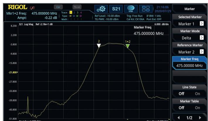
**Bild 6: S11-Messung (li.) und Messung von S21 (Durchgangsdämpfung) in dB (re.)**
