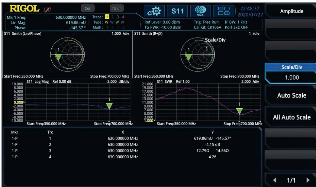
**Bild 4: Verschiedene Fenster der S11-Parameter wie Smith und Polarebene, Rückflussdämpfung in dB und SWR**
