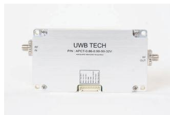
Der leistungsstarke schmalband-GaN-HF-Verstärker UWB Tech TAPCT-0.86-900-50-32V ist ein Best-in-Class-Galliumnitrid-Verstärker, der von 860 MHz bis 900 MHz arbeitet. Dieser PA ist geradezu ideal für kommerzielle Breitband-Plattformen sowie für extreme Anwendungen, da er robust ist und hohe Leistung bietet.
