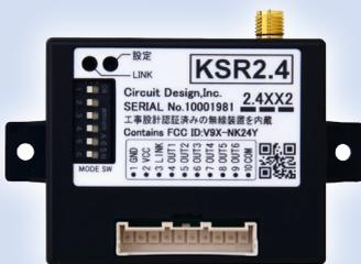
Circuit Design brachte die High/Low-Level-Status-eingangseinheit KST2.4S und die Ausgangseinheit KSR2.4 für industrielle Anwendungen auf den Markt. Beide enthalten das Funkmodul NK-2.4Y, das die FCC-Zertifizierung in USA und die japanische Funkzulassung erhalten hat. In den Einheiten sind das Funkmodul, ein Output-Photo-MOSFET und LEDs zur Kommunikationsüberwachung enthalten. Dies erleich-
